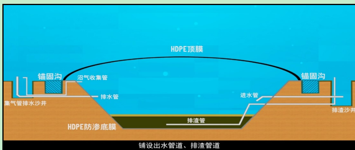
图 3.3-6 黑膜沼气池结构示意图
