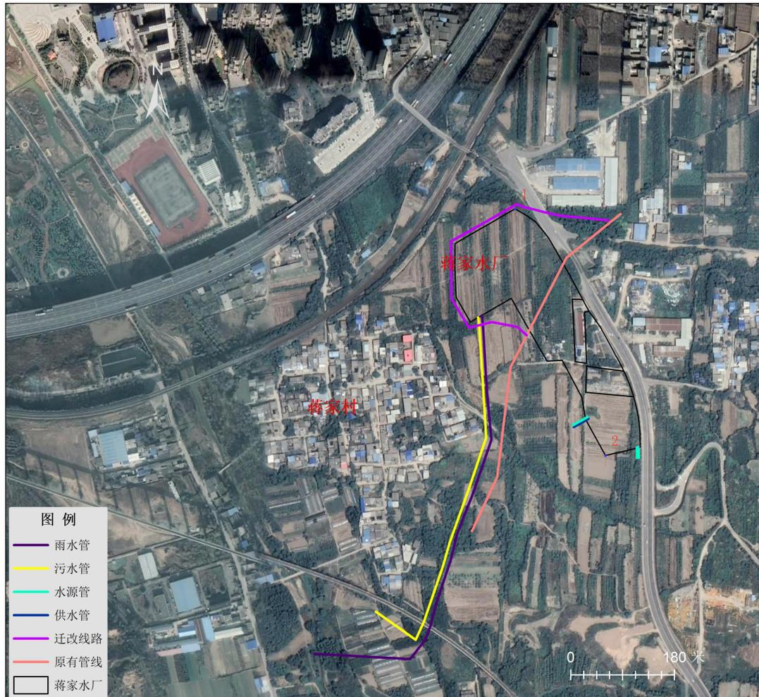
附图 3-1 蒋家水厂拟建配水管网走向示意
